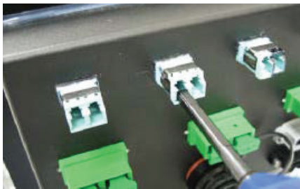
Reinigungsvorgang in SC Kupplung
