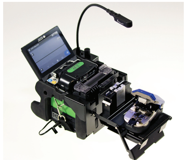
T-57 mit Workstation vorne und LED Arbeitsleuchte
