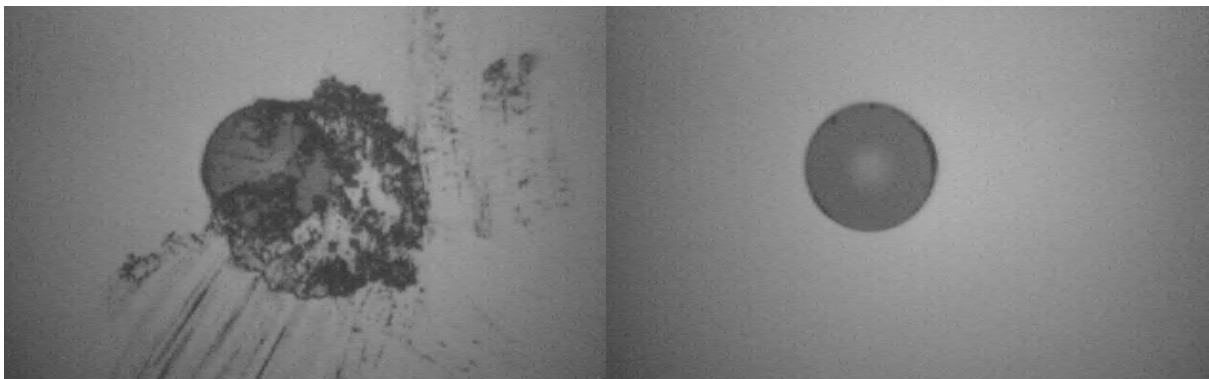
Bild 4.20: Verschmutzte und gereinigte Steckerstirnfläche
